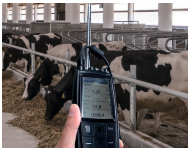
Рис. 5. Прибор фиксирует моментальную и среднюю скорость движения потока воздуха
