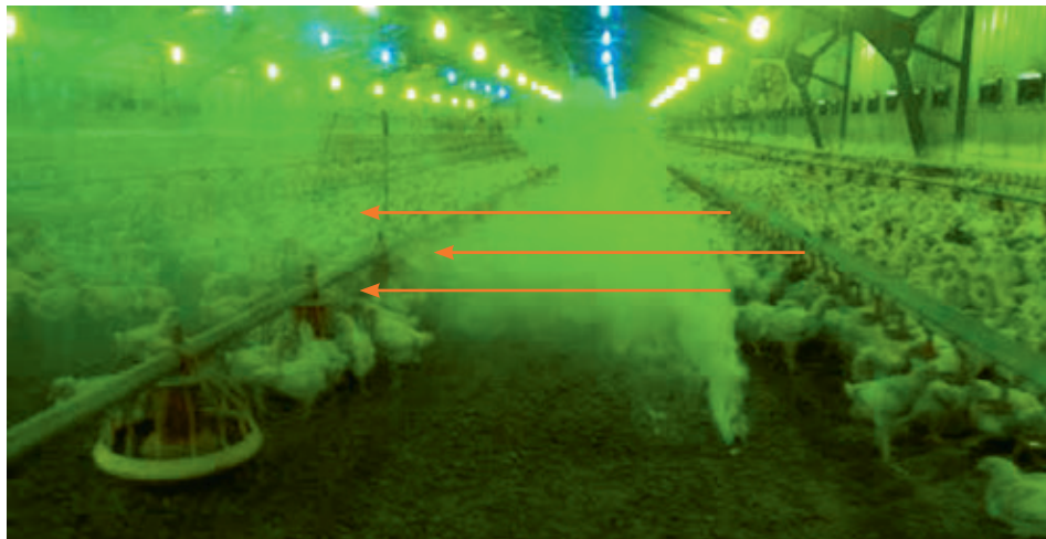
рис. 3. Наглядная проверка движения воздуха над птицей с помощью «дым-теста».
