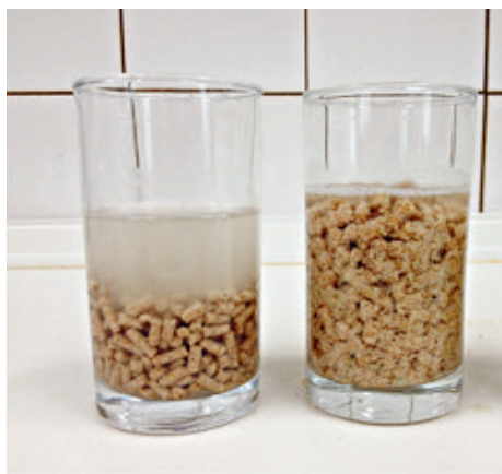
Рис. 6. Процесс набухания: слева — твердые гранулы, справа — мягкие
