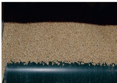
Рис. 9. Применение ленточного транспортера исключает возможность повреждения гранул во время перемещения
