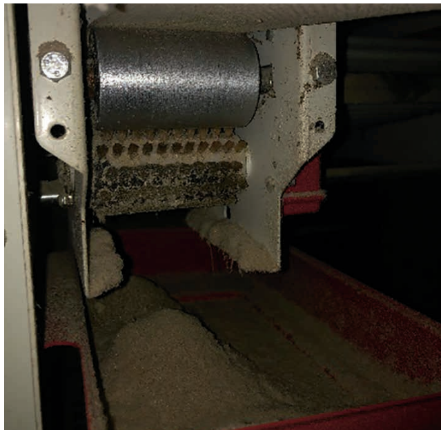
Фото 4. Система удаления пыли с ленты яйцесбора
